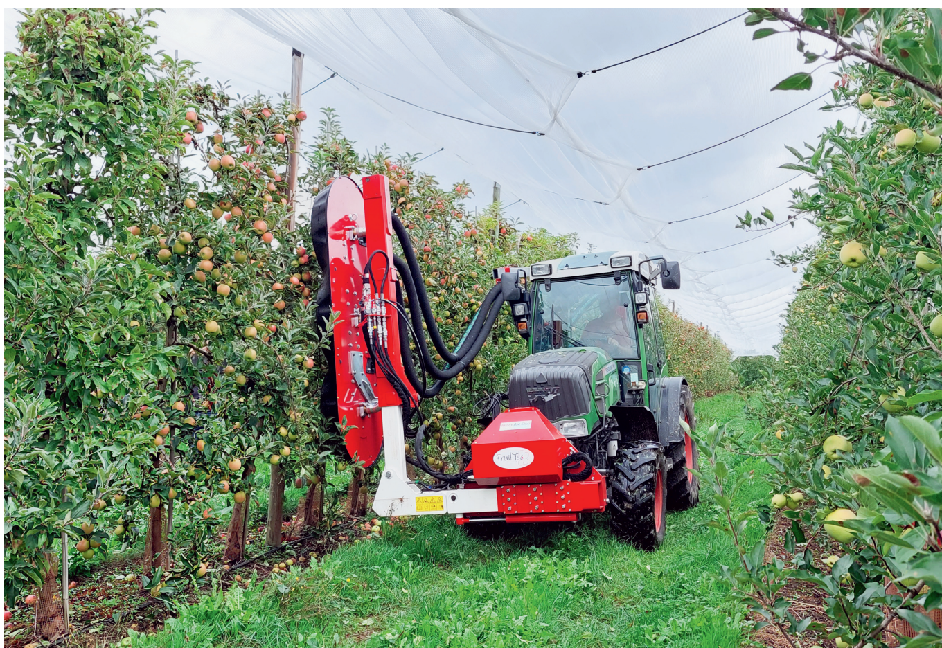
Passage d'une effeuilleuse pneumatique dans un verger. Photo : Agroscope.
