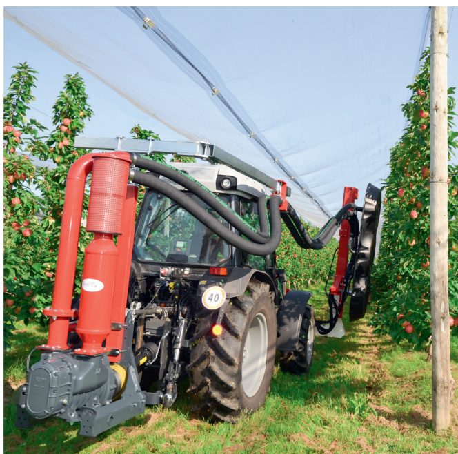
Fig. 5 : Si le mur fruitier est étroit et rectiligne, la tête de l'effeuilleuse peut être guidée près du mur. Photo : Agroscope.
