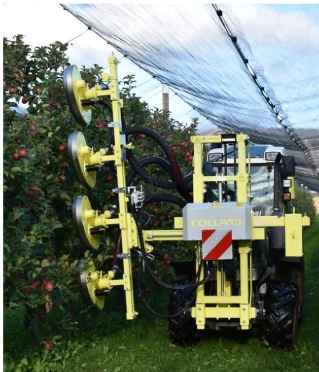
Figure 1: Effeuilleuse Collard dans un verger de Kanzl®
